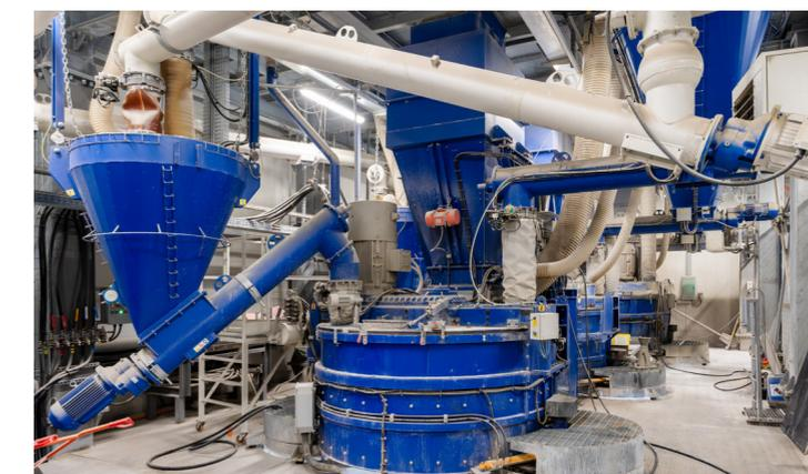
**Centrale à béton automatisée de dernière génération d'une capacité de 500 m<sup>3</sup>/jour à Prega Normandie.**
